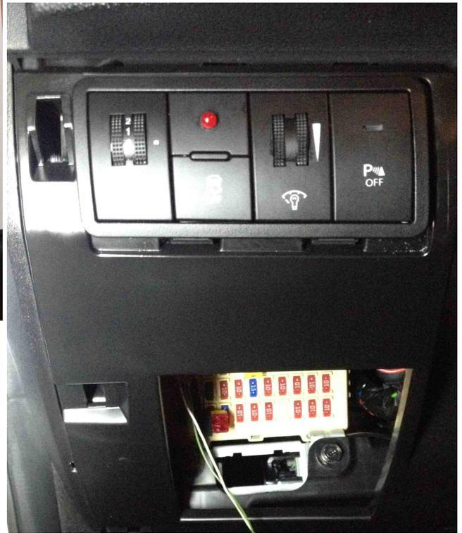
Die Plusleitung mit dem Widerstand an Dauerplus und Minus mit der Sperrdiode an Zündplus.
