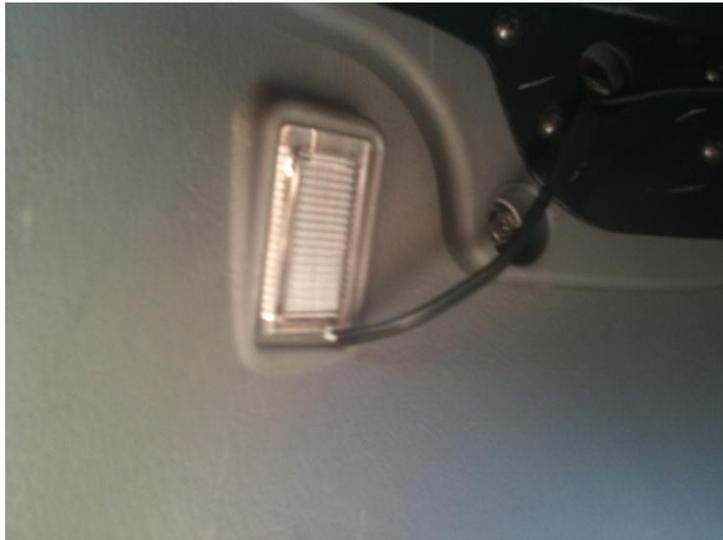
Nun geht das Licht wie gewohnt beim Öffnen des Kofferraums oder einer der Seitentüren an und verbraucht im Endeffekt gleichviel bzw. weniger Strom als die Glühlampe und der Kofferraum ist perfekt ausgeleuchtet.
