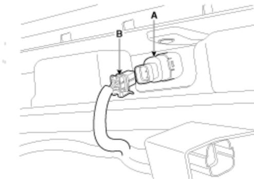
5. Den Sensor (A) herausziehen. Hierzu den Sensorhalter (B) öffnen.
