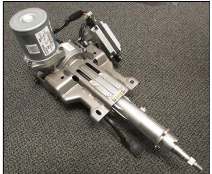
2. Lösen Sie die 3 Schrauben (A), um den MDPS-Motor mit einer T25-Buchse oder einem ähnlichen Werkzeug zu entfernen.
