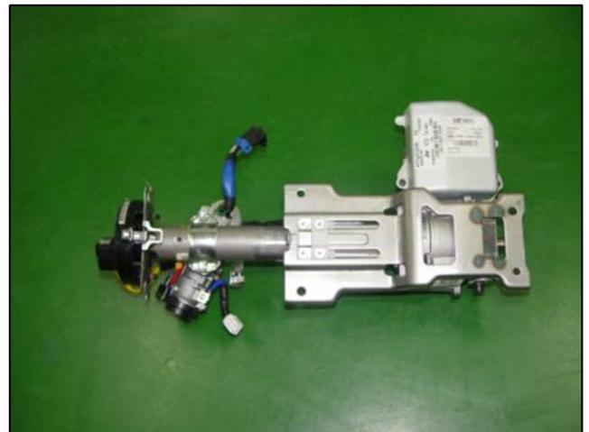
2. Entfernen Sie die 4 oberen Schrauben (A) der Lenksäulenhalterung.
