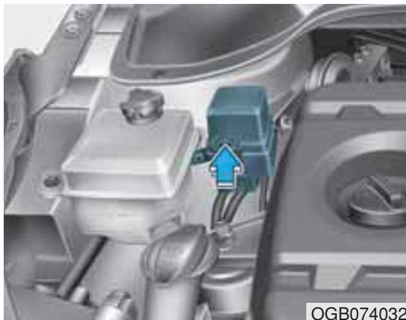
Im Inneren der Sicherungs-/Relaisabdeckungen finden Sie das Sicherungs-/Relaisschaltetikett, welches die Sicherungs-/Relaisnamen und -kapazität beschreibt.
