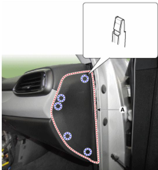
3. Befestigungsschrauben lösen, dann die Armaturentafelverzierung [RH] (A) abnehmen.
