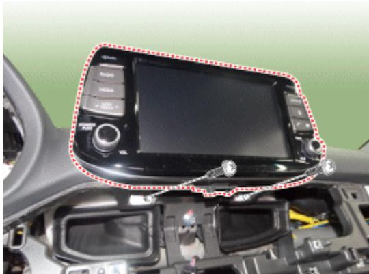
6. Die obere Abdeckung (A) ablösen und dann die AVN-Haupteinheit entfernen.
