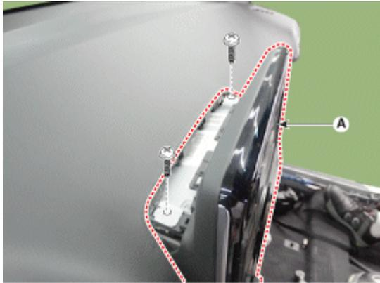
8. Steckverbinder und Kabel (A) abziehen, dann die AVN-Haupteinheit ausbauen.
