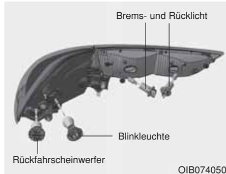
4. Bauen Sie die Lampenfassung aus dem Leuchtengehäuse aus, indem Sie die Fassung gegen den Uhrzeigersinn drehen, bis ihre Rastasen zu den Gehäuseaussparungen ausgerichtet sind.
