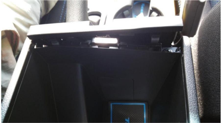
Jetzt erst seitlich lockern, aber nicht so weit anheben das Plastik ist sehr dünn und empfindlich und dann an der Verbindung zwischen Ablage und Schaltkulisse aushebeln.
