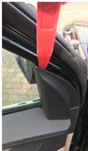
Türverkleidung ist ebenso nur gesteckt. Auf der Unterseite ist eine kleine Ausbuchtung, hier den Keil ansetzen, leicht anhebeln bis sich „Popp“ die erste Steckverbindung löst. Nun rundherum weiter anhebeln – je nach eigenem Gefühl mit dem Keil oder per Hand.
