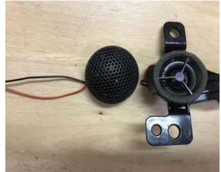
2 Haltenasen aufbohren; rotes/schwarzes Kabel des Steckers direkt da wo am Hochtöner angelötet abzwicken, Kabel auf Oberseite vorsichtig ablösen (Draht nicht verletzen!); Hochtöner raushebeln (einer war ziemlich fest geklebt), andere Drähte und Kondensator entfernen.
