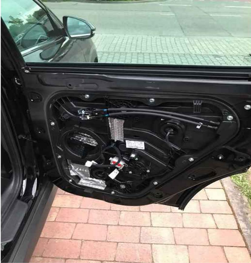
Lautsprecherstecker abziehen, Lautsprecher abschrauben (alles wie vorne). Am Anschlussterminal nun schonmal die Polung einzeichnen, + / - ist bei beiden Lautsprechern identisch belegt.
