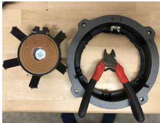
Jetzt zunächst die Etons lose auf die Halterung auflegen. Achtet hierbei darauf, dass die Anschluss terminals gegenüber liegen. Dann die Verschraubungen zunächst vorbohren. Etons nochmal abnehmen, die eigentlichen Schrauben rein- und wieder rausdrehen.
