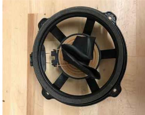
Statt mit einer Säge habe ich dann die Verstrebungen mit einem geschicktem Seitenschneider abgezwickelt, Kabel am Anschlussterminal ebenso abknipsen.
