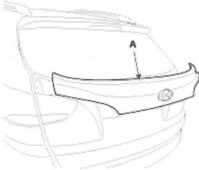
3. Rückfahrkamera (A) durch Lösen der Schrauben (2 Stck.) ausbauen.
