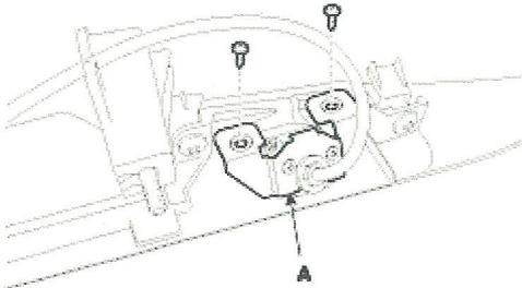
4. Steckverbinder (A) abziehen, dann das Rückfahrkameramodul (B) ausbauen.
