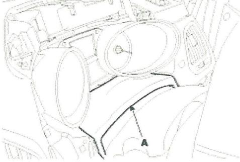
4. 4 Schrauben herausdrehen und dann die Instrumentenblockabdeckung (A) aus dem Gehäuse herausziehen.
