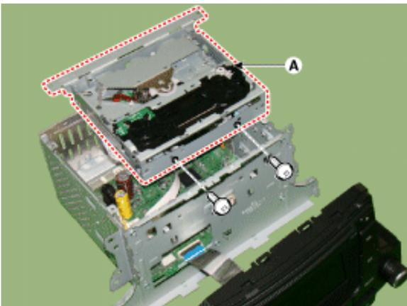
4. Flachbandkabelsteckverbinder (A) zwischen Gerät und Laufwerk abziehen.
