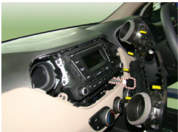
3. Befestigungsschrauben der Audio-Haupteinheit lösen.
