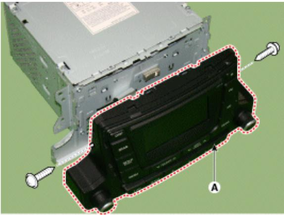
2. Befestigungsschrauben lösen und obere Abdeckung (A) der Haupteinheit abnehmen.
