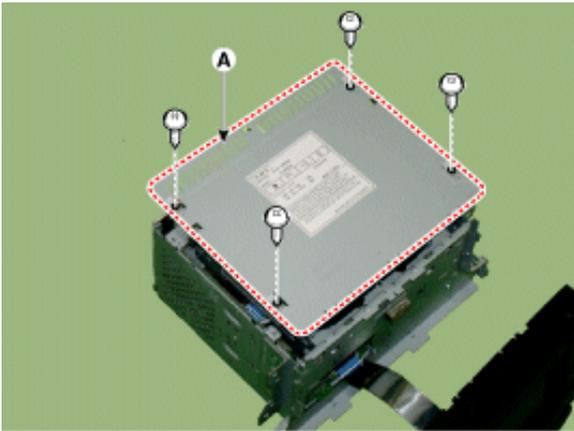
3. Befestigungsschrauben lösen und CD-ROM-Laufwerk (A) von der Haupteinheit abtrennen.
