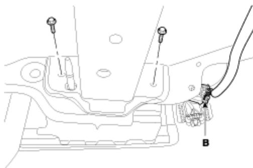
6. Clips und Befestigungsschrauben lösen, dann hinteren Stoßfängers (A) ausbauen.
