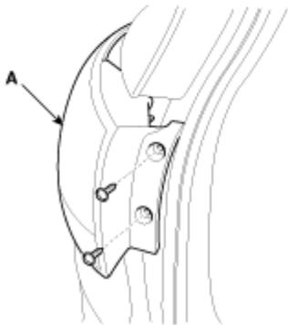
3. Seitliche Befestigungsschraube des hinteren Stoßfängers lösen. Dann Stoßfänger abnehmen.
