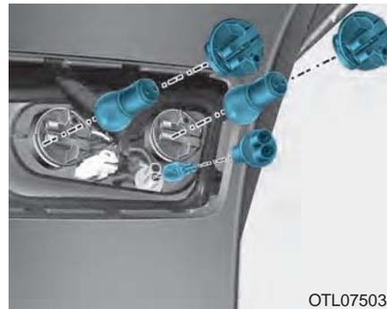
4. Bauen Sie die Lampenfassung vom Leuchtengehäuse ab, indem Sie die Fassung gegen den Uhrzeigersinn drehen, bis ihre Zungen mit den Gehäuseausparungen fluchten.
